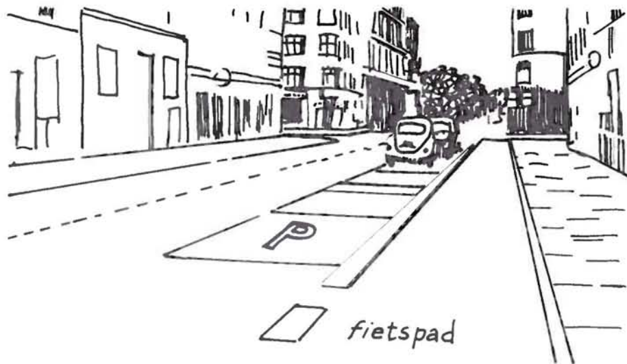
Afbeelding 11. Een buurtontsluitingsweg in Österbro, Denemarken, zo belijnd dat tussen de rij geparkeerde auto's en het trottoir een fietsstrook is aangelegd.
