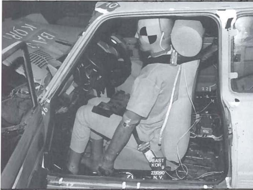
Crashtest om na te gaan wat de invloed van roest is op de veiligheid.
