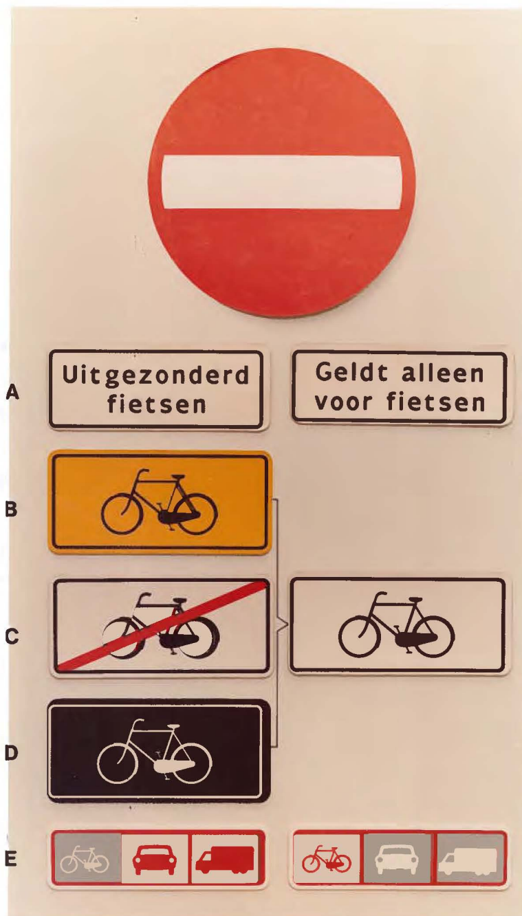
Foto 1. Fotografische weergave van de vijf systemen voor de categorie fietsen bij een verbodsbord.
