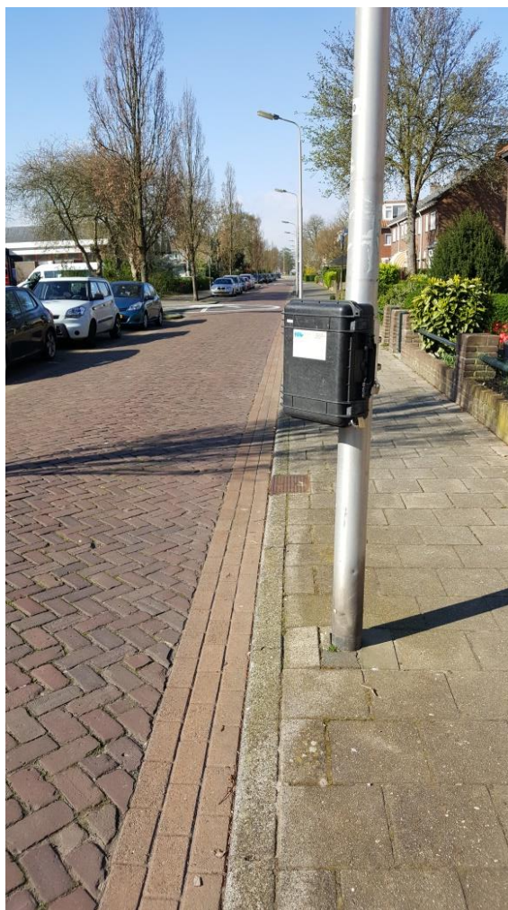
Afbeelding 2.1. Een geplaatste wegkantradar
