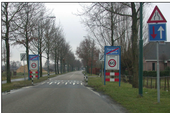
Afbeelding 4.5. De Nieuwevaart is nog niet juist ingericht: wel een goede Zone 60-poort maar asmarkering i.p.v. kantmarkering.
