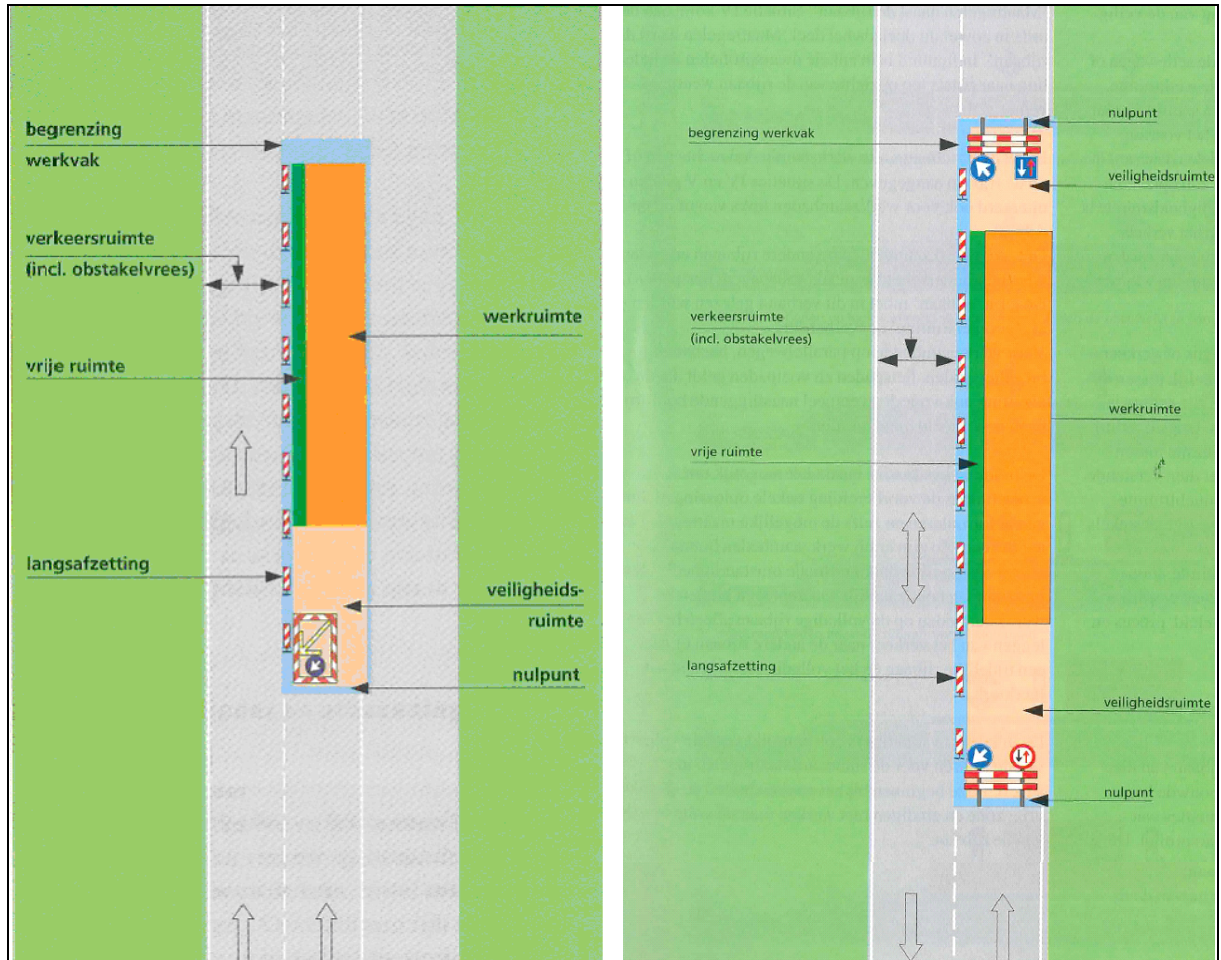
Afbeelding A. Werkvak op een autosnelweg.
