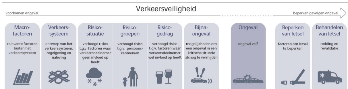
Afbeelding 18.1. SWOV-verkeersveiligheidsketen en indeling van oorzaken die een rol spelen bij het ontstaan en de letselernst bij verkeersongevallen.
