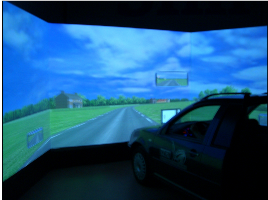
Afbeelding B.1. De rijimulator en de opstelling van de mock-up.
