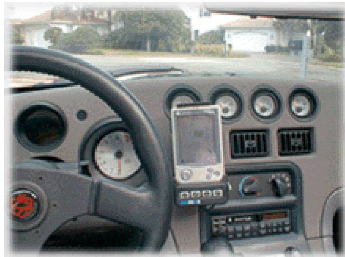
Afbeelding B.15. GTTS van ComRoad AG ®, variant 1DIN body met aangesloten PDA als scherm te gebruiken, Bron/copyright: ComRoad AG ® ( http://www.comroad.com/ ).
