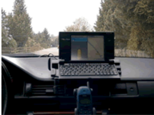
Afbeelding B.24. 'Doe-het-zelf'-navigatiesystemen. Een notebook, een GPS-ontvanger en een cd met navigatiesoftware..... Klaar.
